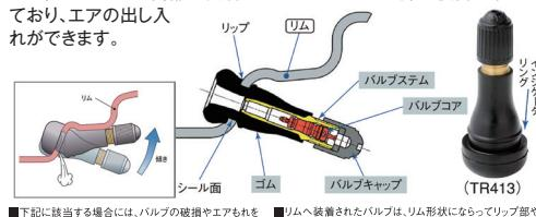
■下記に該当する場合には、バルブの破損やエアを漏れ起こす恐れがありますのでスナップインバルブは使用せずクラシックバルブを使用下さい。
